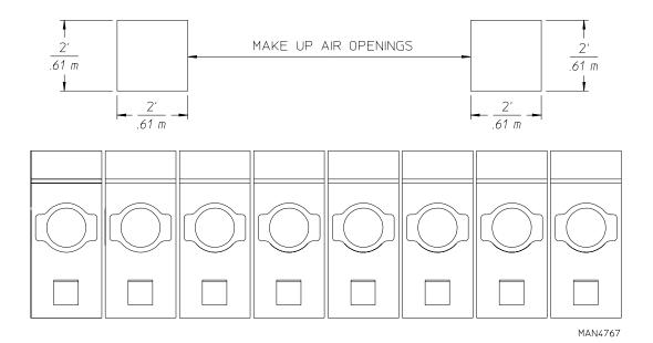
TYPICAL INSTALLATION SHOWING MAKE - UP AIR OPENINGS
